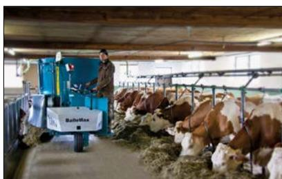
Von Anfang an als Selbstfahrer konzipiert, setzt dieser Mischer den Massstab in seiner Klasse. Mit dem 36-PS-Yanmar-Dieselmotor oder 15-kW-Elektromotor ausgestattet und der automatischen lastabhängigen Mischdrehzahlregulierung, kann jederzeit im optimalen Wir-
